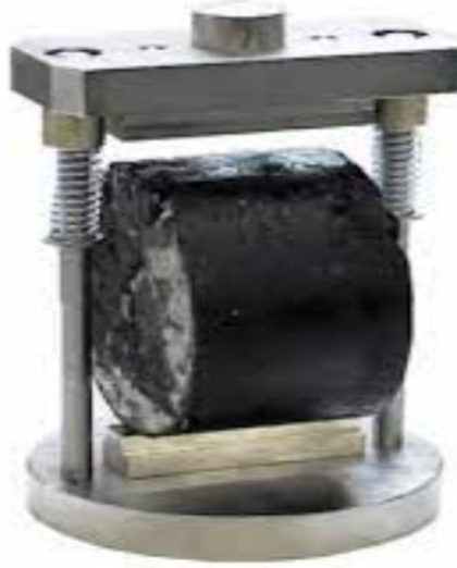
Şekil 22. Marshall numuneleri için indirekt çekme deney aparatı
