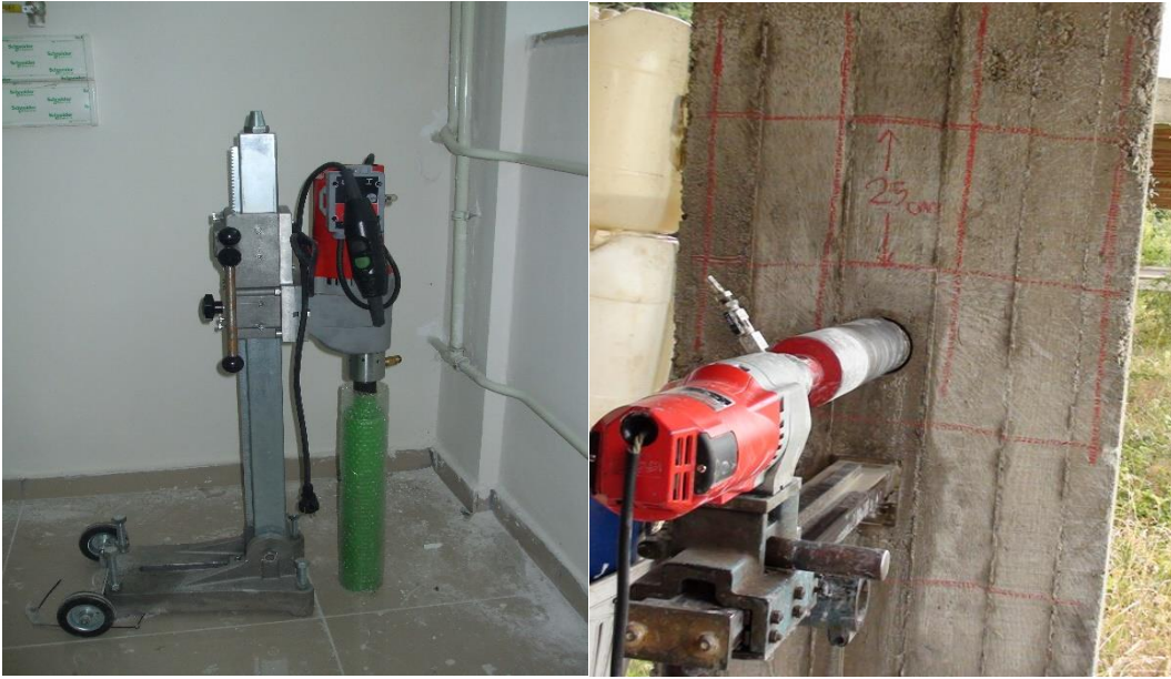
Şekil 2. Karot makinesi ve yerinde uygulanması
