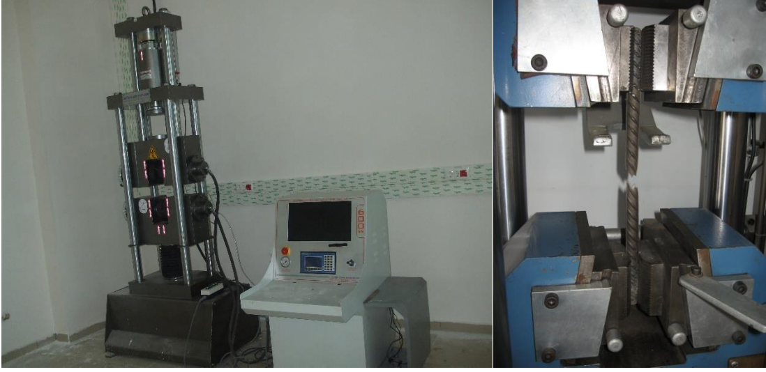
Şekil 1. Tam otomatik bilgisayar kontrollü hidrolik çeneli çelik çekme cihazı
