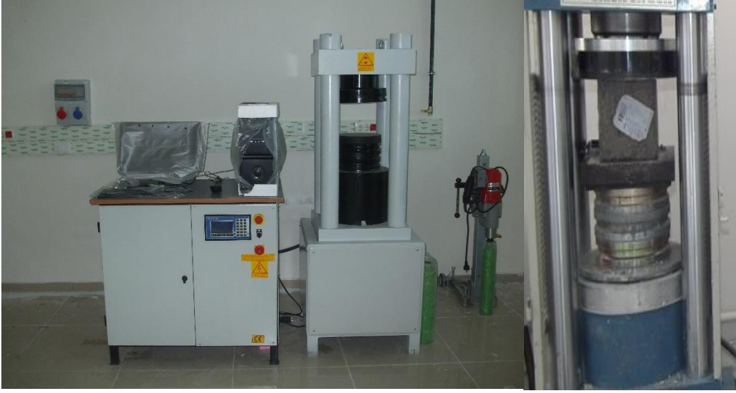
Şekil 19. Tam otomatik bilgisayar kontrollü beton test presi ve uygulama örneği
