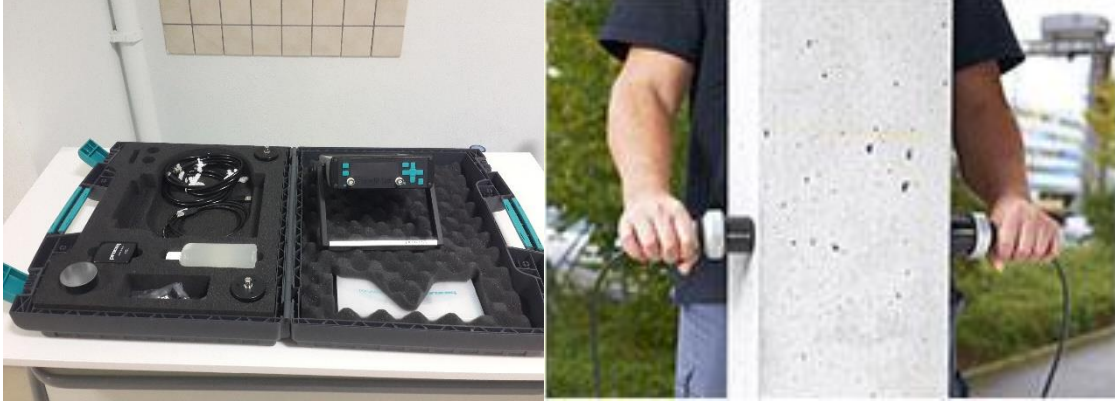
Şekil 22. Ultrasonik test cihazı ve uygulaması
